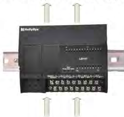
Рисунок 12-1 Рекомендуемый способ отвода тепла
