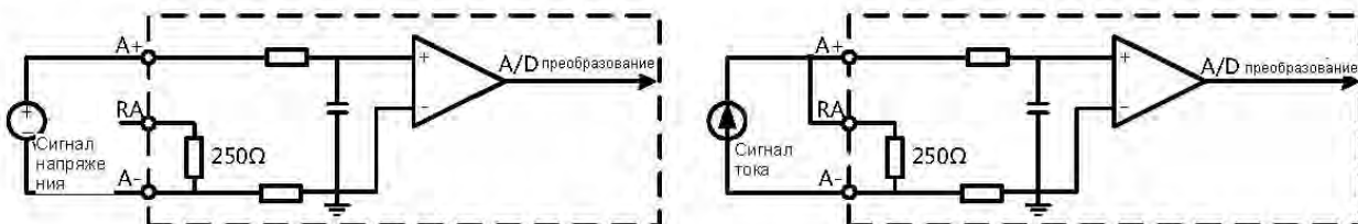
Рисунок 2-18 Аналоговые дифференциальные входные каналы
