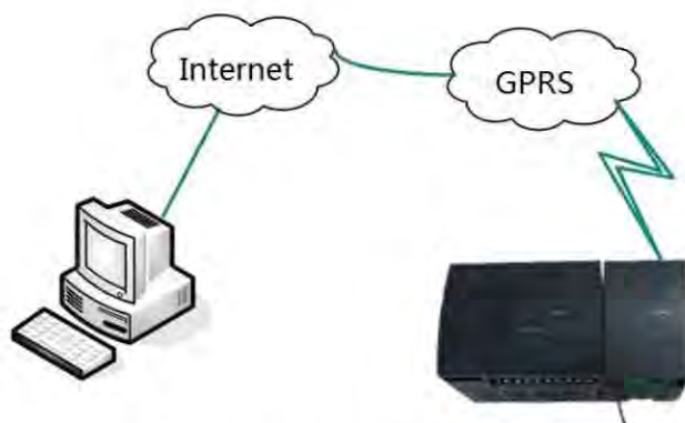
Рисунок 2-24 Режим связи GPRS
