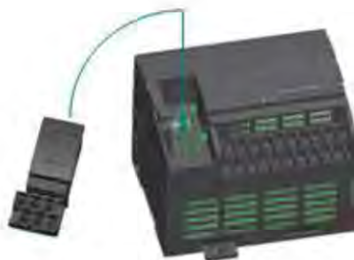
Рисунок 4-4 Установка панели расширения LE5600
