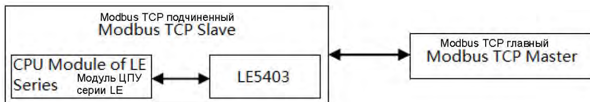
Рисунок 10-6 Сеть Modbus TCP
