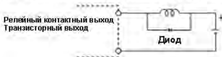
Рисунок 12-15 Типовая схема подавления для коммутации индуктивных нагрузок постоянного тока
