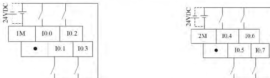
Рисунок 5-1 Определение верхних клемм и схема подключения / Определение нижних клемм и схема подключения
