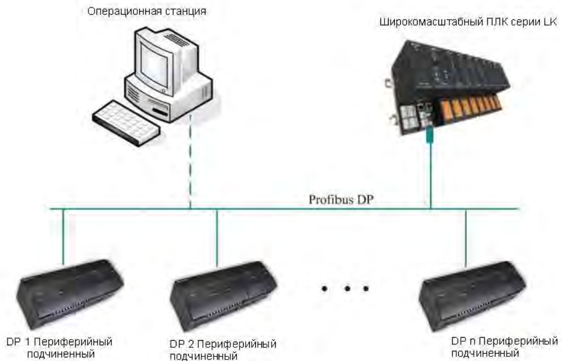
Рисунок 2-22 Режим Profibus DP
