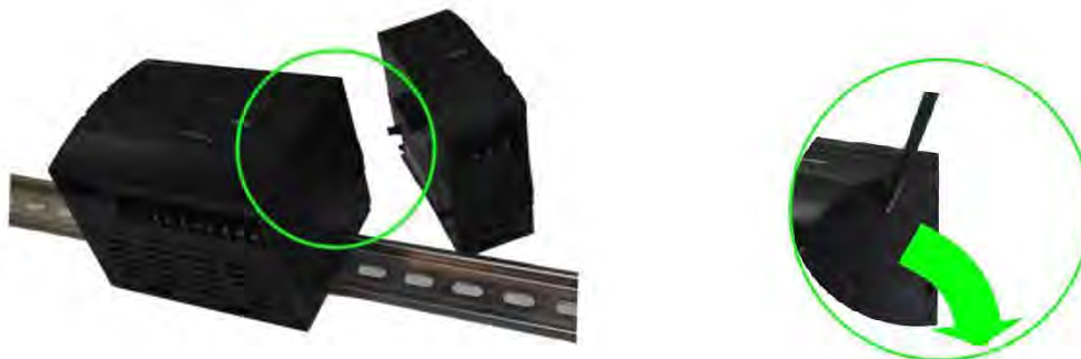
Рисунок 12-8 Снятие крышки разъема
