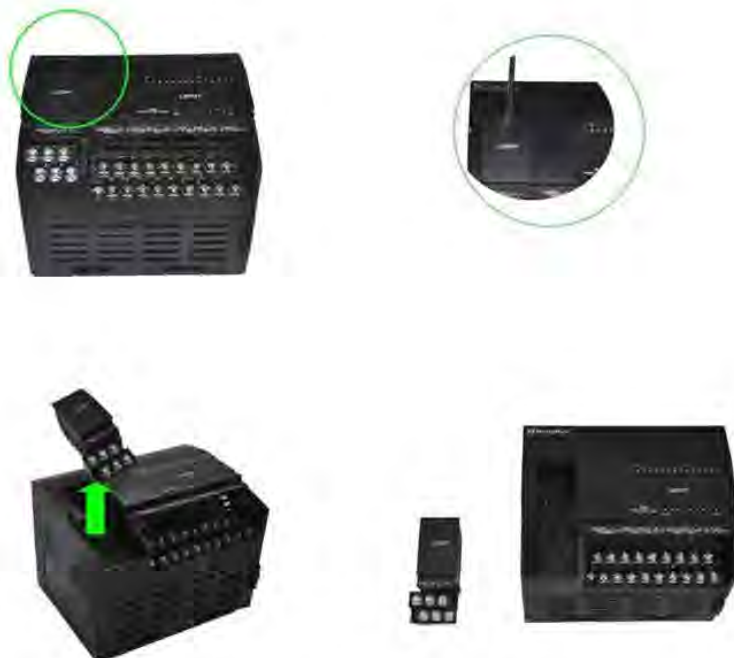
Рисунок 12-12 Извлечение панели расширения
