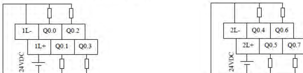
Рисунок 6-1 Определение верхних клемм и подключение Определение нижних клемм и подключение
