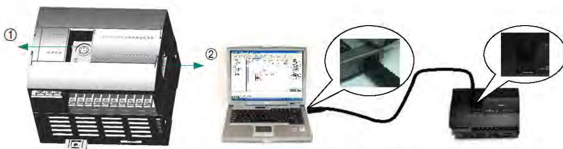
Рисунок 3-2 Схема подключения связи
