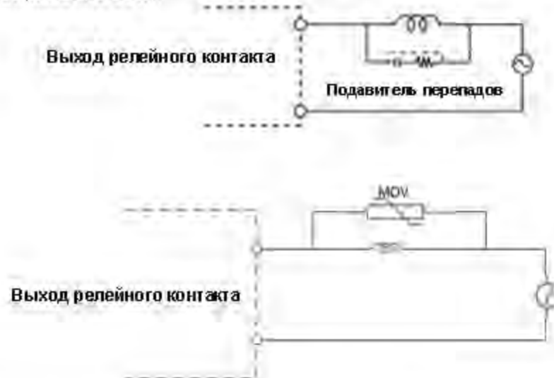
Рисунок 12-16 Типовой контур подавления для коммутации индуктивных нагрузок переменного тока
