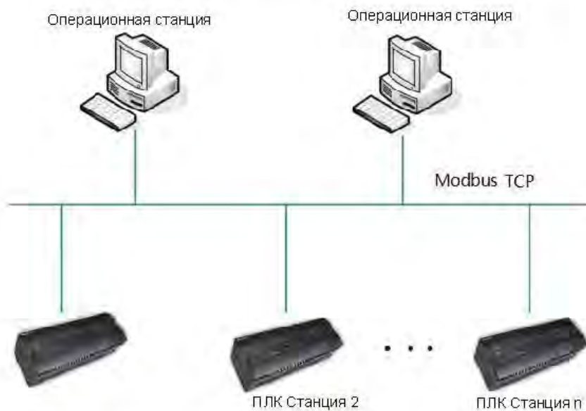
Рисунок 2-23 Режим связи Ethernet
