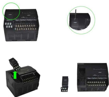
Демонтаж панели расширения LE5621
