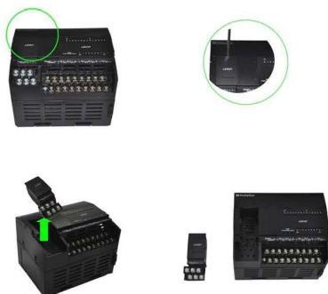
Демонтаж панели расширения LE5601
